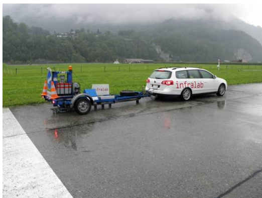
Fotos vom 24.09.2010: Messeinrichtung FWD von Infralab SA
